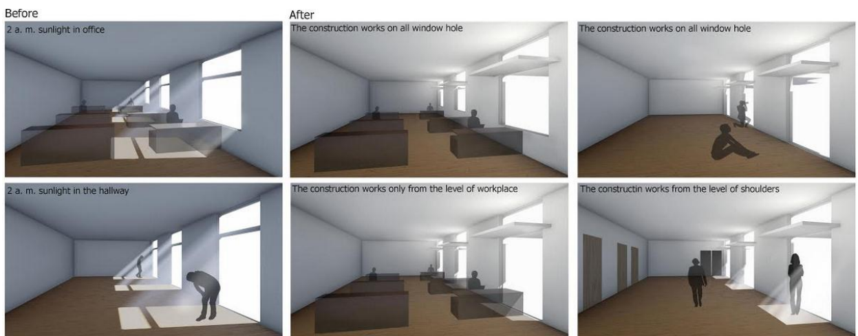
Рисунок 5. Изменение освещенности естественным светом при применении исследуемой конструкции
