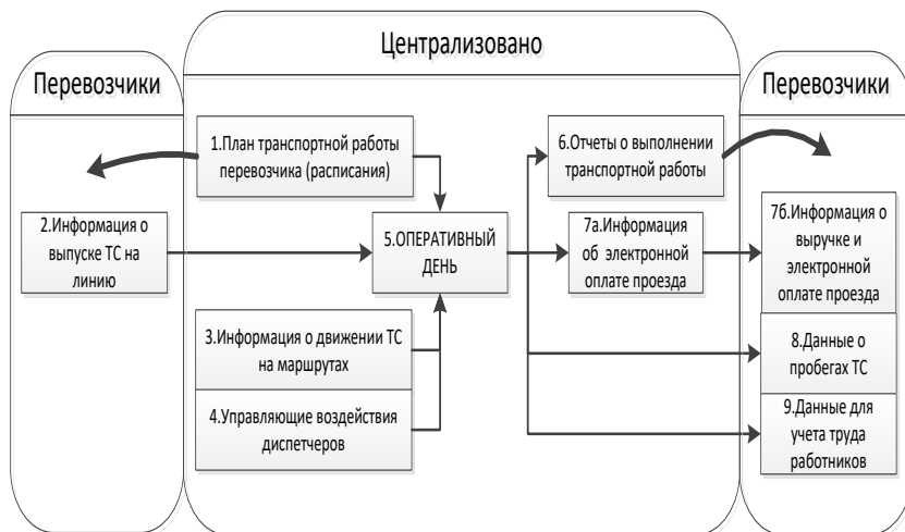
Рисунок 3а – Вариант централизованного управления и централизованного сбора информации
