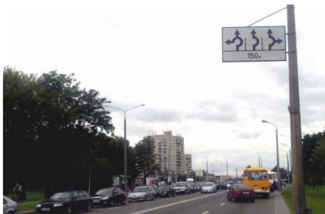
Рисунок 13 – Специальный дорожный знак «Схема движения по полосам» на одном из подходов к кольцевой развязке в одном уровне
