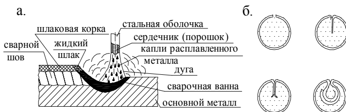
Рис. 2.7. Схема сварки порошковой проволокой (а); сечения порошковой проволоки (б)
