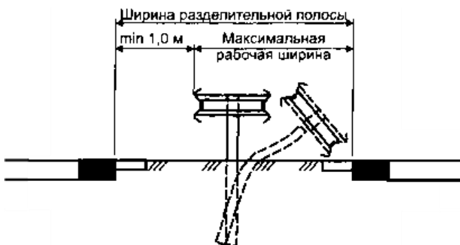
Рисунок 7.5 – Требование к установке двухстороннего ограждения на разделительной полосе
