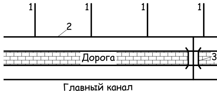
Рис. 7.2. Схема впуска боковых каналов в главный канал: 1 – боковой канал; 2 – придорожный канал; 3 – мост или труба
