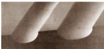
Рис. 1.5. Профили изотропного травления кремния
