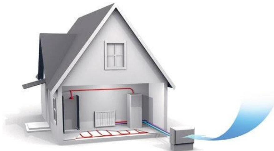
Рисунок 2. Тепловой насос «воздух-вода»
