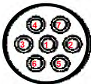
Рис. П1.8. Нумерация канатов в пучке
