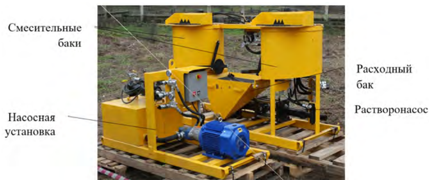
Рис. 4.23. Инъекционная установка УСИ 175/265/80
