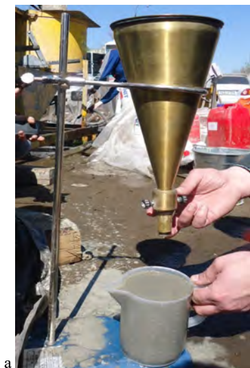
Рис. 4.25. Конус для определения текучести: а – внешний вид, б – схема (размеры являются внутренними и указаны в мм)
