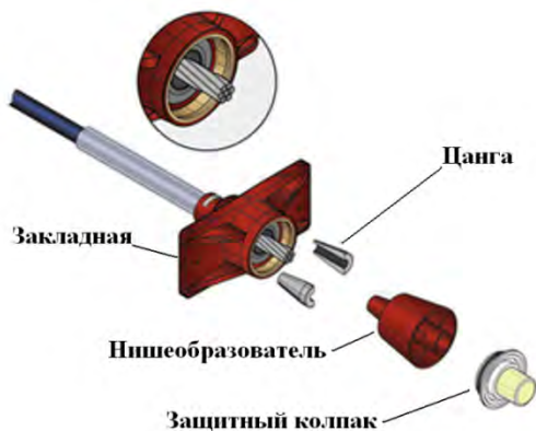
Рис. 2.2. Комплект поставки системы unbounded monostrand
