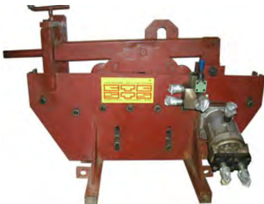
Рис. 3.6. Проталкивающее приспособление СТС (РФ)
