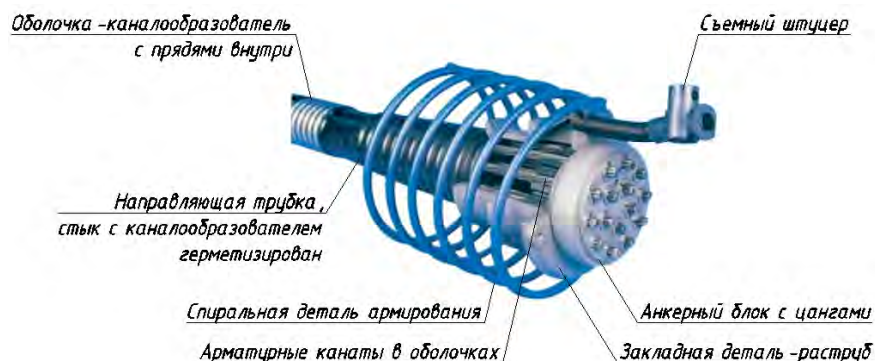
Рис. 5.2. Принципиальная схема анкерного узла системы multistrand
