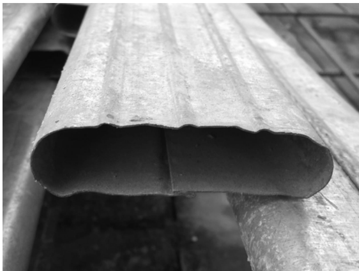
Рис. ПЗ.2. Оболочка-каналообразователь, один из вариантов исполнения
