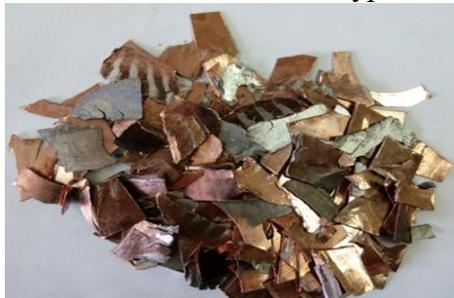
Рисунок 1 – Магнийсодержащая лигатура
