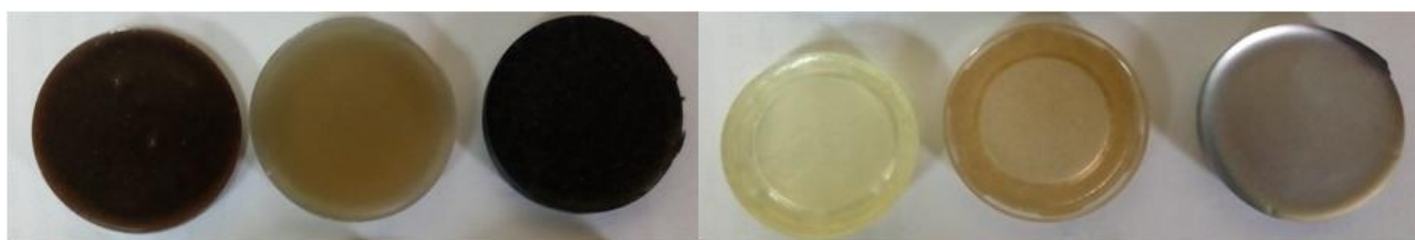
Рис.1. Образцы композитов на основе эпоксидной смолы с различными наполнителями (слева на направо: дубовая пыль, маршалит, графит, без наполнителя, кремнезем, алюминиевая пудра)
