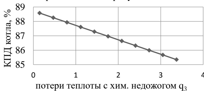
Рисунок 1.2 – Зависимость КПД котла от потерь с химическим недожогом.
