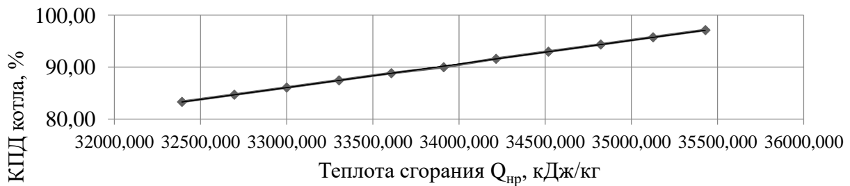
Рисунок 1.1 – Зависимость КПД котла от теплоты сгорания топлива (согласно обратного метода).
