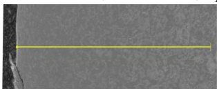
Рис. 1. Структура стали после легирования частицами свинца в режиме сверхглубокого проникания и последующего газового азотирования, \times 10
