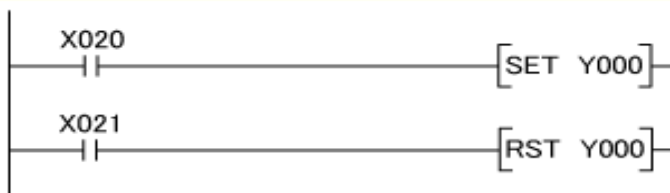
Рис.15. Инструкции SET и RST
