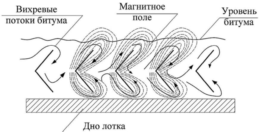
Рис. 2.9. Схема продольного разреза лотка с указанием течения битума вокруг спиралей
