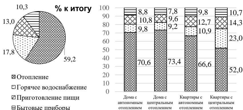
Рисунок 1.2. Структура общего конечного потребления энергии в домашних хозяйствах по основным целевым направлениям использования
