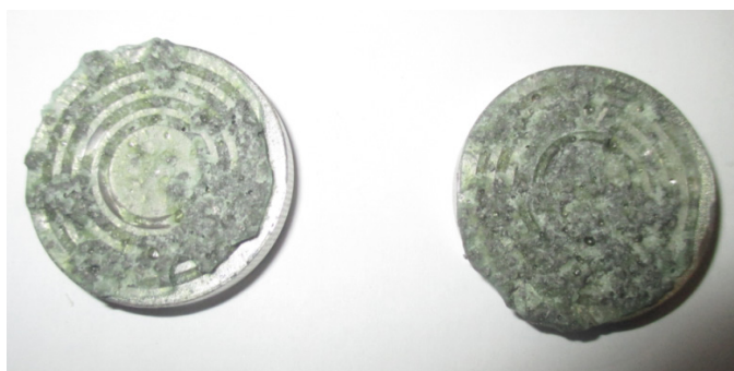
Рисунок 4 – Вид образца № 1 (клей DP 8805NS) после разрыва
