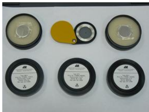
Рисунок 23. Эталонные спектрометрические источники типа ОСАИ (слева) типа ОСГИ (справа)
