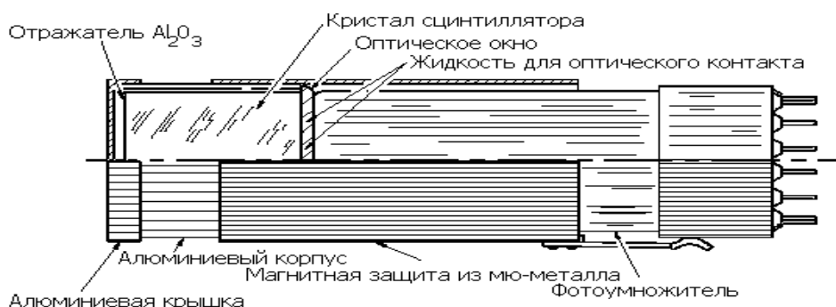
Рисунок 12. Сцинтиллятор и ФЭУ
