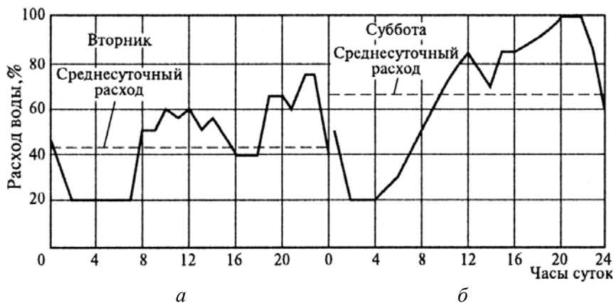
Рис. 2.3. Суточный график горячего водоснабжения жилого района: а – сутки среднего водопотребления; б – сутки максимального водопотребления
