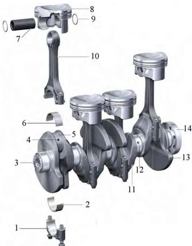
Рис. 1.1. Поршневая группа и кривошипно-шатунный механизм:
