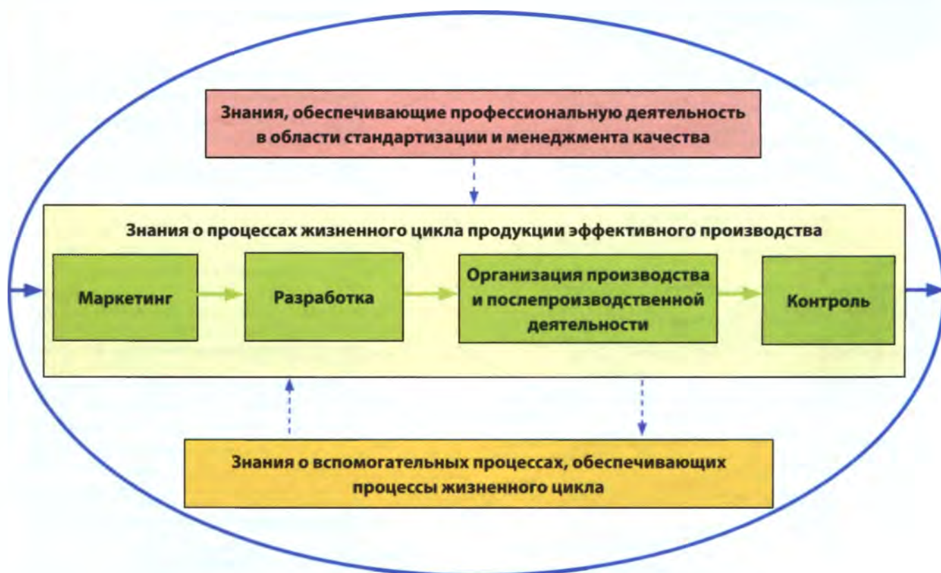
Рисунок 3 – Функциональная модель деятельности инженера по стандартизации и менеджменту качества на типовом промышленном предприятии как комплексного процесса
