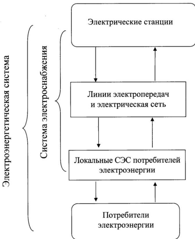
Рис. 3.1 Схема взаимосвязи потребителей с системой электроснабжения
