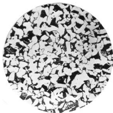
Рисунок 1 – Микроструктура среднеуглеродистой стали: феррит (светлый) и перлит
