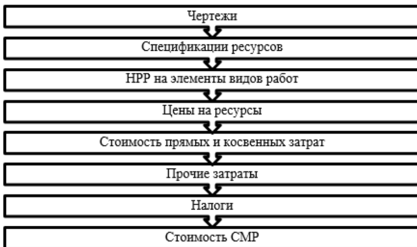
Рисунок 1 – Алгоритм формирования сметной стоимости строительства, на основании нормативов расхода ресурсов в натуральном выражении
