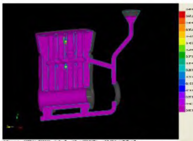
Рис.6 – Вероятность формирования усадочных дефектов (пористости) в отливке с использованием экспериментальных данных о фазовых переходах сплава АК9
