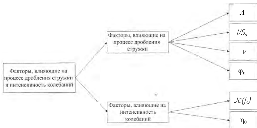
Рис. 3.46 - Структура факторов, влияющих на процесс вибрационного точения
