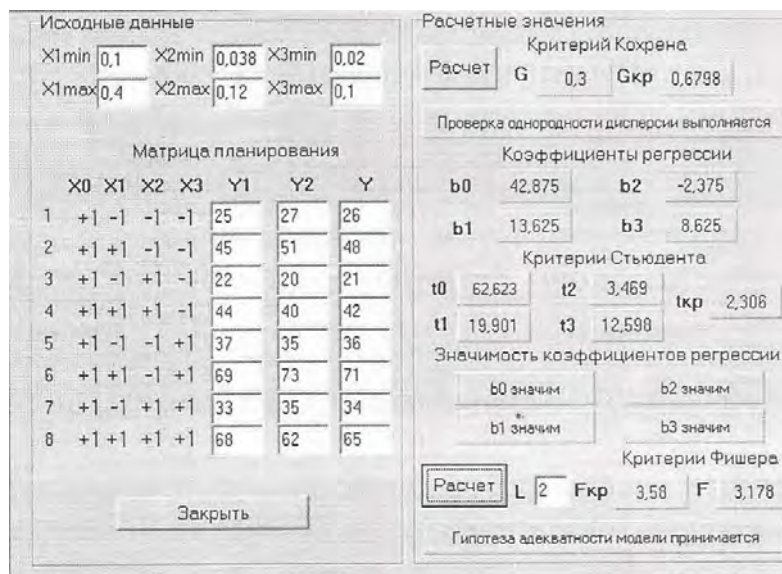
Рис. 3.36 – Результаты расчетов влияния параметров колебаний на шероховатость поверхности по методу полного факторного эксперимента 2^3
