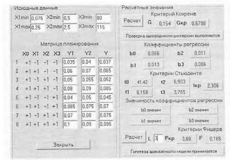
Рис. 3.26 – Результаты расчетов влияния режимов резания на A min по методу полного факторного эксперимента 2 3
