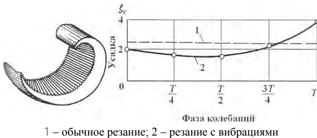
Рис. 3.20 – Изменение коэффициента усадки в процессе срезания одного элемента стружки
