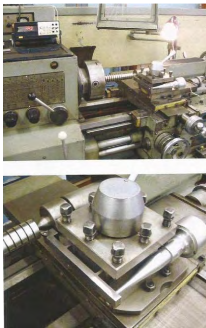
Рис. 3.44 - Система инструмент-акустический преобразователь
