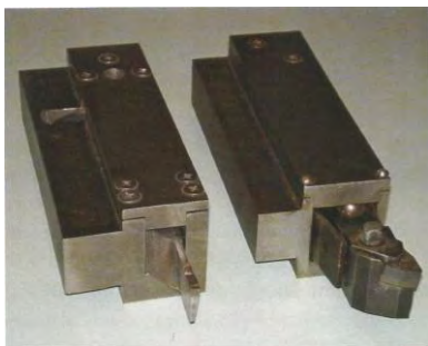
Рис. 3.42 - Инструменты для вибрационного точения
