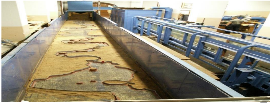
Рисунок 18. – Лабораторная установка для изучения режима течений в водохранилищах. На переднем плане модель водохранилища Криницы
