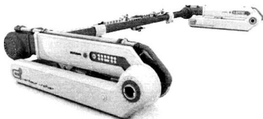
3D-принтер для печати бетоном в сложенном состоянии
