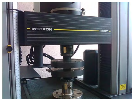
Рисунок 2 – Испытательная машина Instron 5567.
