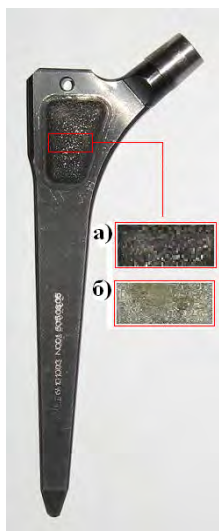
а) исходная структура вставки из пористого титана; б) структура с порами, заполненными костной тканью Рисунок 1 – Ножка эндопротеза бесцементной фиксации
