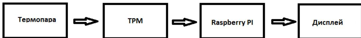
Рис. 2 – Схема измерения термопрофилей пайки
