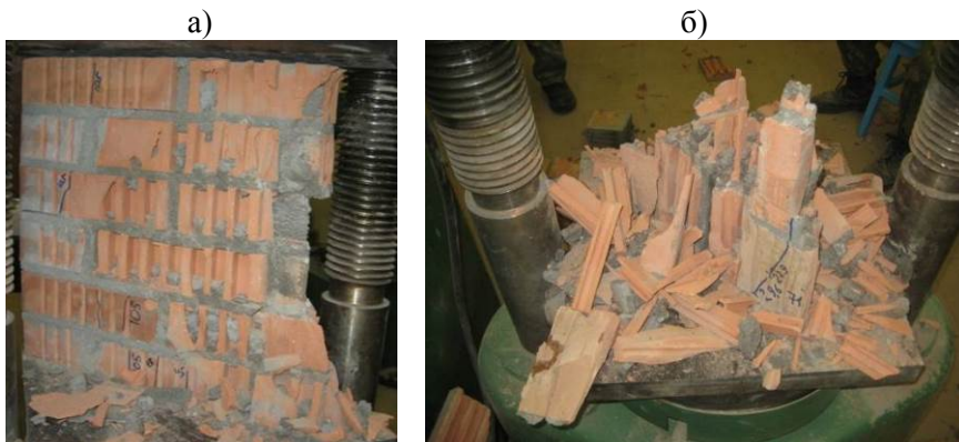
Рис. 1. Характер разрушения образцов каменной кладки выполненной: а – из кирпича керамического пустотностью 30%; б – из камня керамического пустотностью 42,3%
