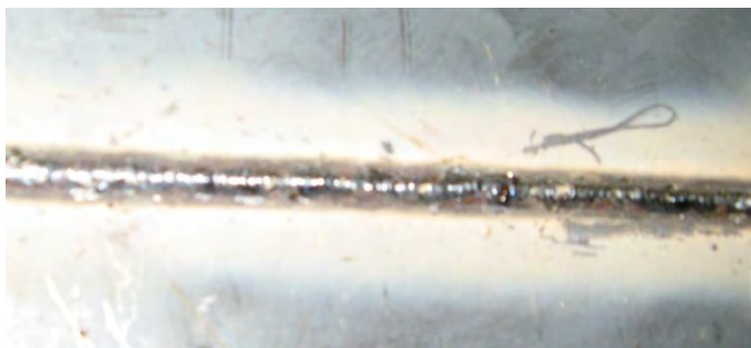
Рисунок 2 – Внешний вид наплавленного валика
