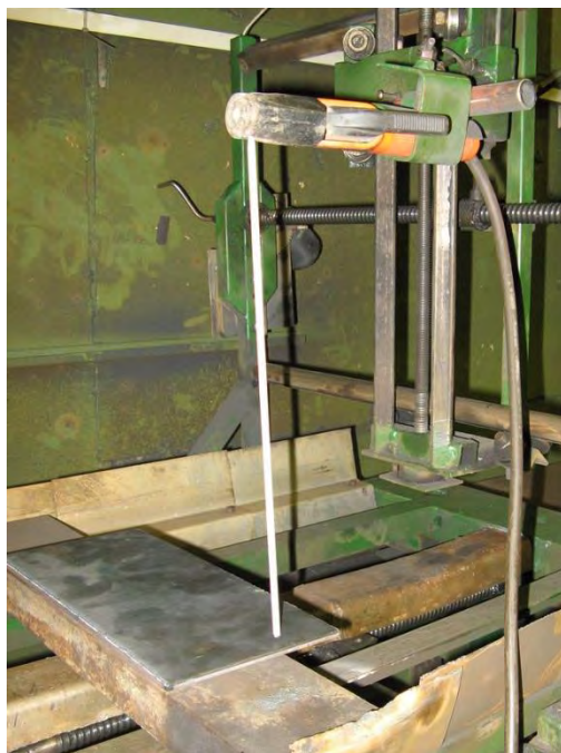
Рисунок 1 – Экспериментальная установка для наплавки в автоматическом режиме подачи электрода
