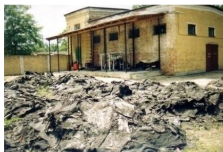
Рис. 2. Складирование в бурты КБО: вид слежавшегося исходного сырья перед измельчением в товарную дисперсную продукцию (пат. ВУ 2811).
