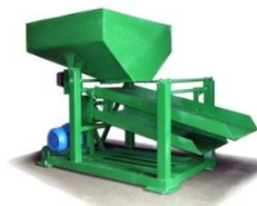
Рис. 5. Классификатор битумного порошка (пат. ВУ 9992).
