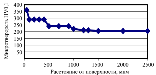
Рис. 5. Микротвердость стали 20 при борировании в кипящем слое
