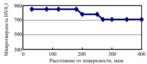
Рис. 6. Микротвердость стали 4X5MФС при борировании в кипящем слое
