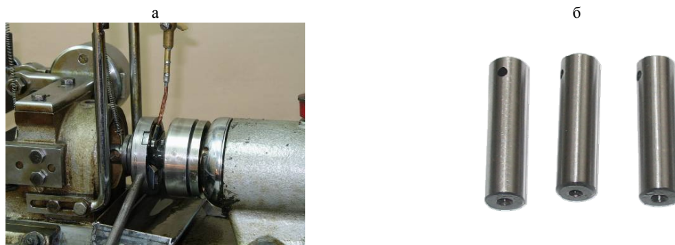
Рис. 2. Общий вид установки и образцы, используемые при испытании износостойкости трехвалковым методом: а – установка I-47-K-54; б – комплект образцов для исследований
