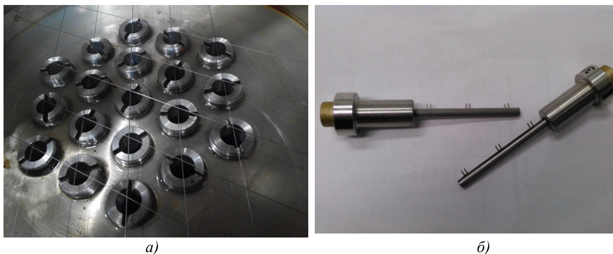
Рисунок 3 – Исследовательская часть измерительной системы: а – сетчатый датчик (верхняя камера); б – стержневые датчики
