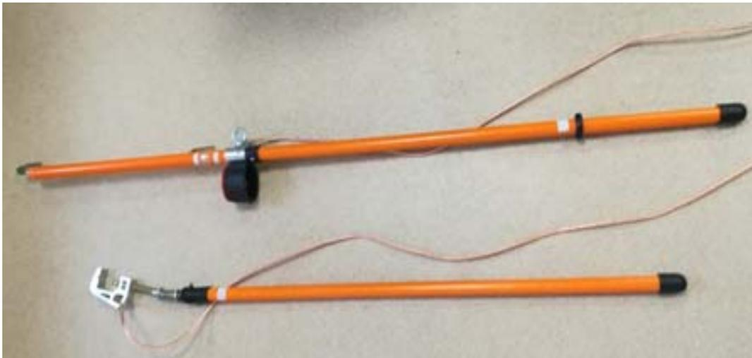
Рисунок 4 – Измеритель наведенного напряжения ИНН-15
