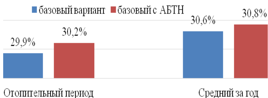
Рисунок 2 – Сравнение эксергетического КПД энергосистемы Беларуси в 2020 г. при работе АЭС и электродкотлов и тоже с АБТН на ТЭЦ
