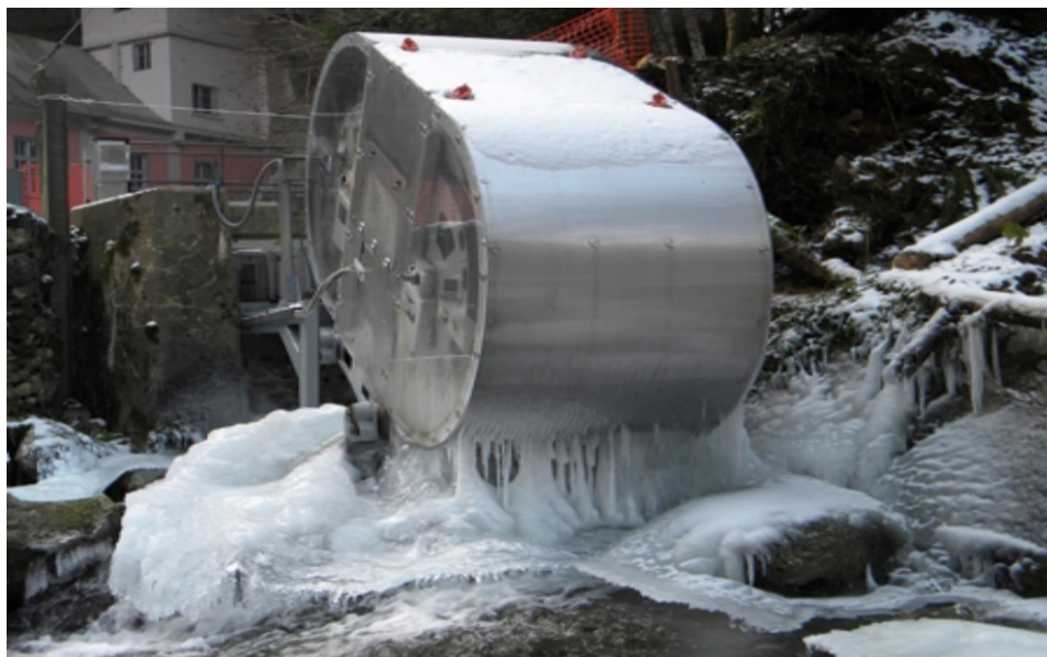
Рисунок 3 – Турбина СТЕФФ в зимних условиях
