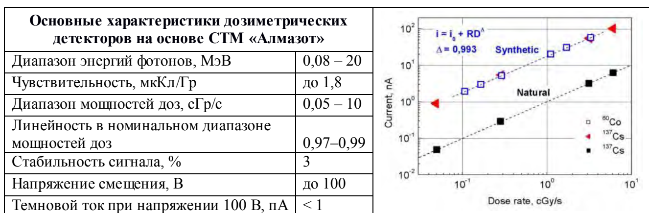
Рис. 3. Зависимости тока фотоионизации от мощности дозы \gamma -квантов для детекторов на основе СТМ «Алмазот» и природного алмаза типа IIa
