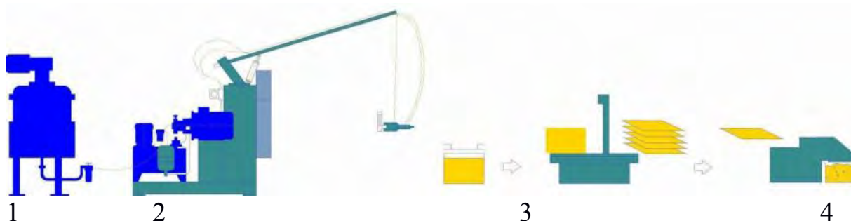
Рисунок 1. - Состав комплекса оборудования для производства сорбента Пенопурм ®
