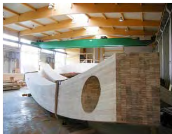
Рисунок 3 – Клееные конструкционные элементы
