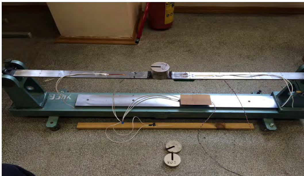
Рисунок 1 – Испытательная установка – балка, с подключенными к ней датчиками
