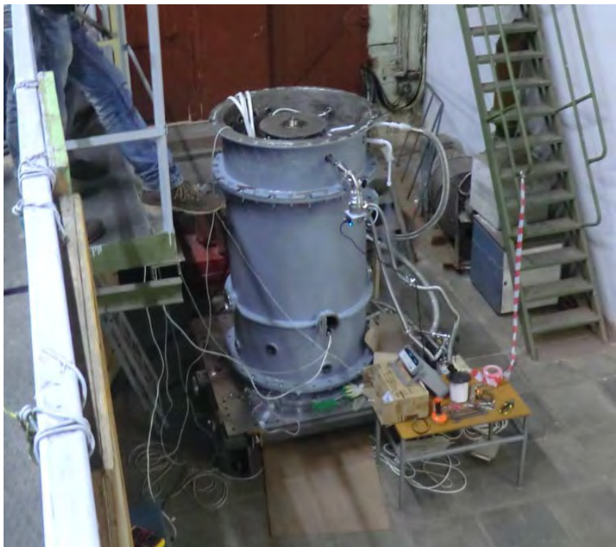
Рисунок 3 – КНЭ на испытательном стенде
