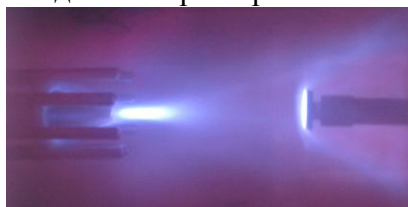
Рисунок 2 – Фотография процесса воздействия компрессионного плазменного потока на образец
