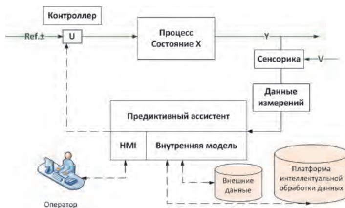
Рис. 1. Схема включения предиктивного ассистента в систему контроля производства второго уровня: u – корректировка контроллера; y – наблюдаемые параметры; v – помехи измерений; x – состояние процесса
