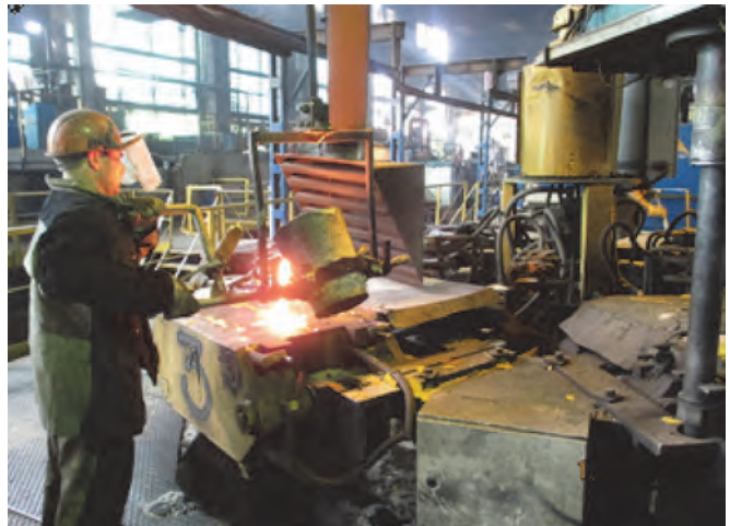
Рис. 6. Шестипозиционная карусельно-кокильная машина мод. 49108 для литья в облицованный кокиль. Позиция заливки
