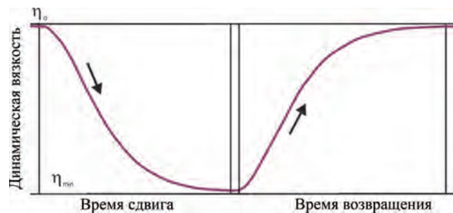
Рис. 4. Ход изменений вязкости тиксотропной системы во время сдвига и при возвращении в состояние равновесия (модель процесса) [3]
