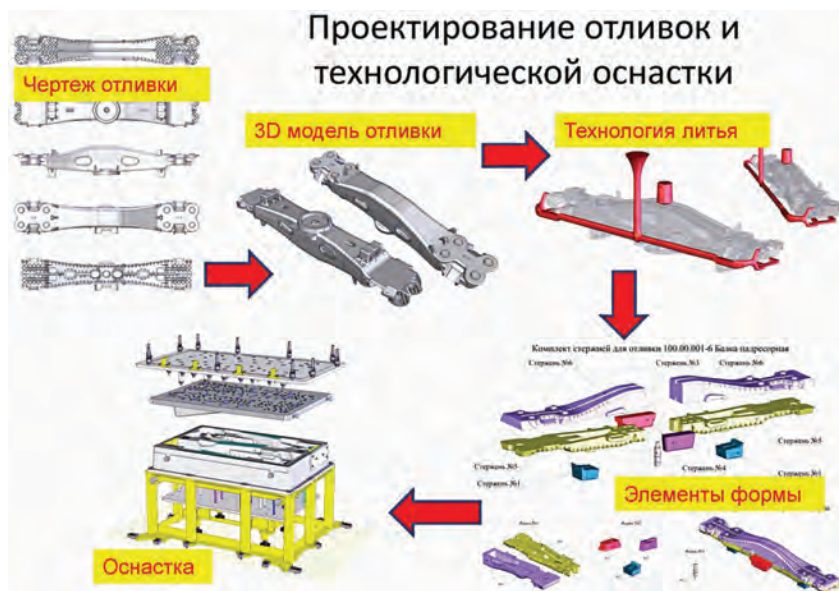
Рис. 4. Схема создания литейной технологической оснастки
