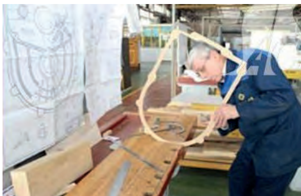
Рис. 3. Варианты изготовления модельной оснастки: а – ручная работа модельщика; б – работа станка с ЧПУ ОАО «БЕЛНИИЛИТ»
