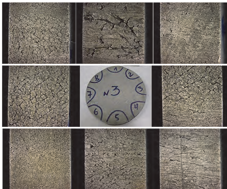
Рис. 3. Поперечный макротемплет и внешний вид поверхности после стравливания окалины с подката диаметром 120 мм марки стали 45
