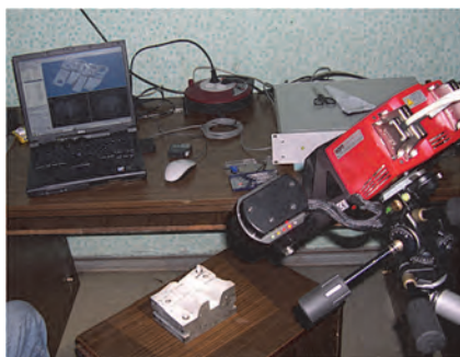
Процесс оцифровки оснастки с применением системы ATOS фирмы GOM mbH
