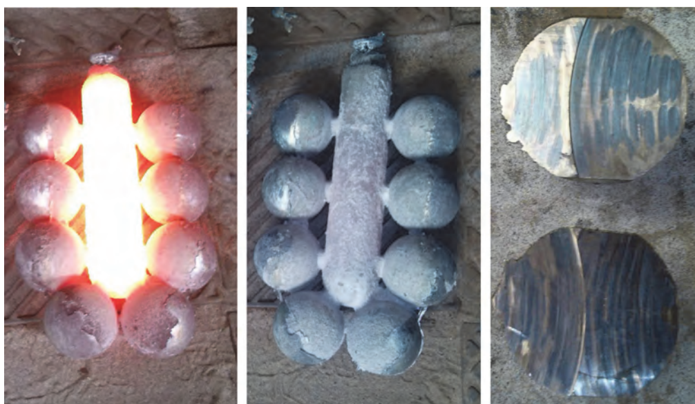
Рис. 4. Отлитые чугунные шары диаметром 100 мм с содержанием хрома 10% с литниковой системой и резы шаров после испытаний
