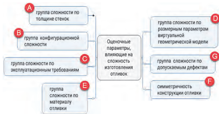
Рис. 1. Составляющие группы параметров оценки технологической сложности отливки/литейной технологии
