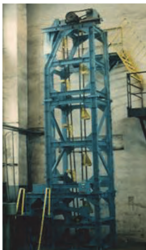
Рис. 2. Стенд П1755 для испытаний на ударную стойкость
