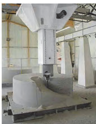
Прямое фрезерование блока из песчано-полимерной смеси (фирма EEW-PROTEC GmbH, Германия)
