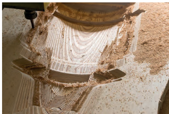
Рис. 3. Варианты изготовления модельной оснастки: а – ручная работа модельщика; б – работа станка с ЧПУ ОАО «БЕЛНИИЛИТ»
