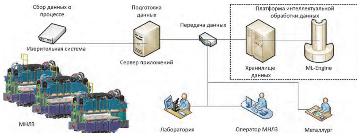
Рис. 2. Развертывание системы технологической поддержки процесса
