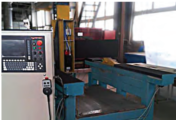
Рис. 5. Общий вид станка с ЧПУ разработки ОАО «БЕЛНИИЛИТ» мод. П1915 для изготовления модельной оснастки
