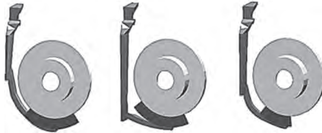
Рис. 3. Примеры литниковых систем с минимизацией турбулентности
