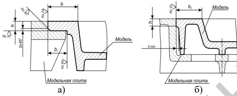
Рисунок 2 – Крепление моделей-фальшивок к подмодельным плитам:
