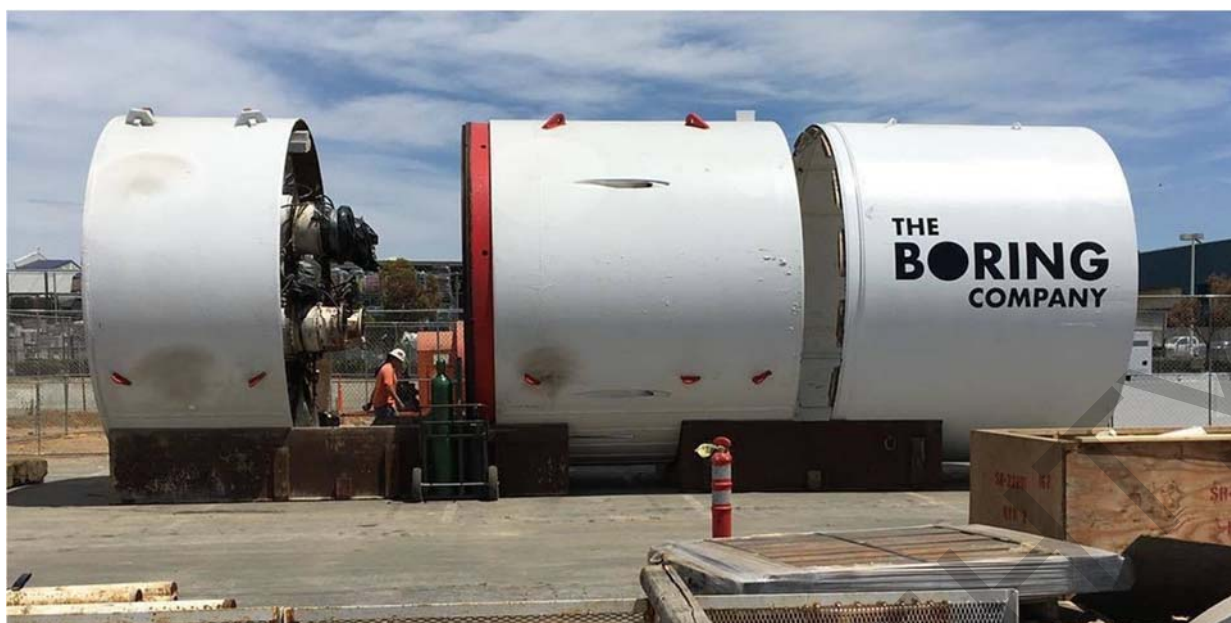
Рисунок 4 –тоннелепроходческая машина «Godot» The Boring Company
