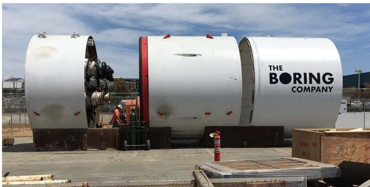
Рисунок 4 –тоннелепроходческая машина «Godot» The Boring Company
