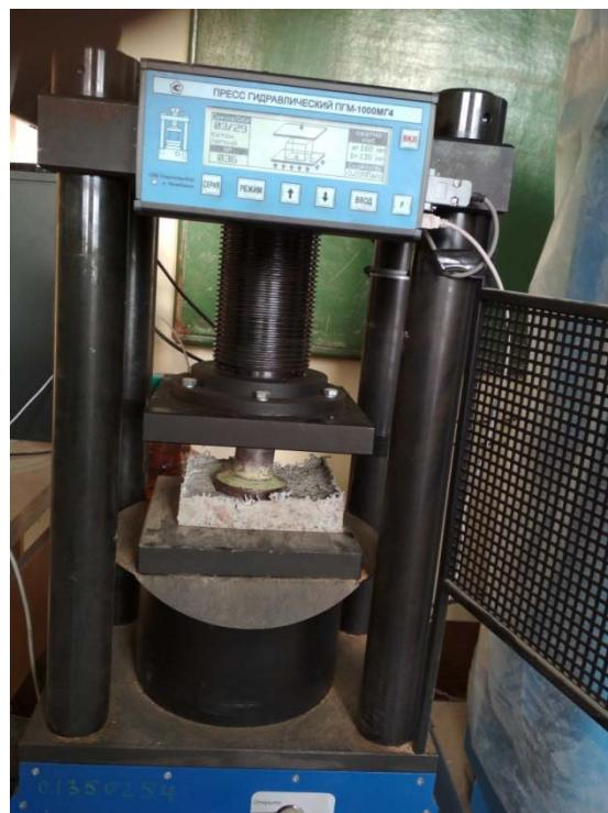
Рисунок 2 – Испытание образца на гидравлическом прессе ПГМ-1000МГ4
