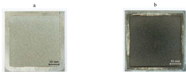
Рисунок 3 – Образцы элементов экранов с двухслойным композиционным покрытием: а – до обработки; б – после обработки магнитоплазменным компрессором
