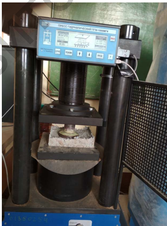
Рисунок 2 – Испытание образца на гидравлическом прессе ПГМ-1000МГ4
