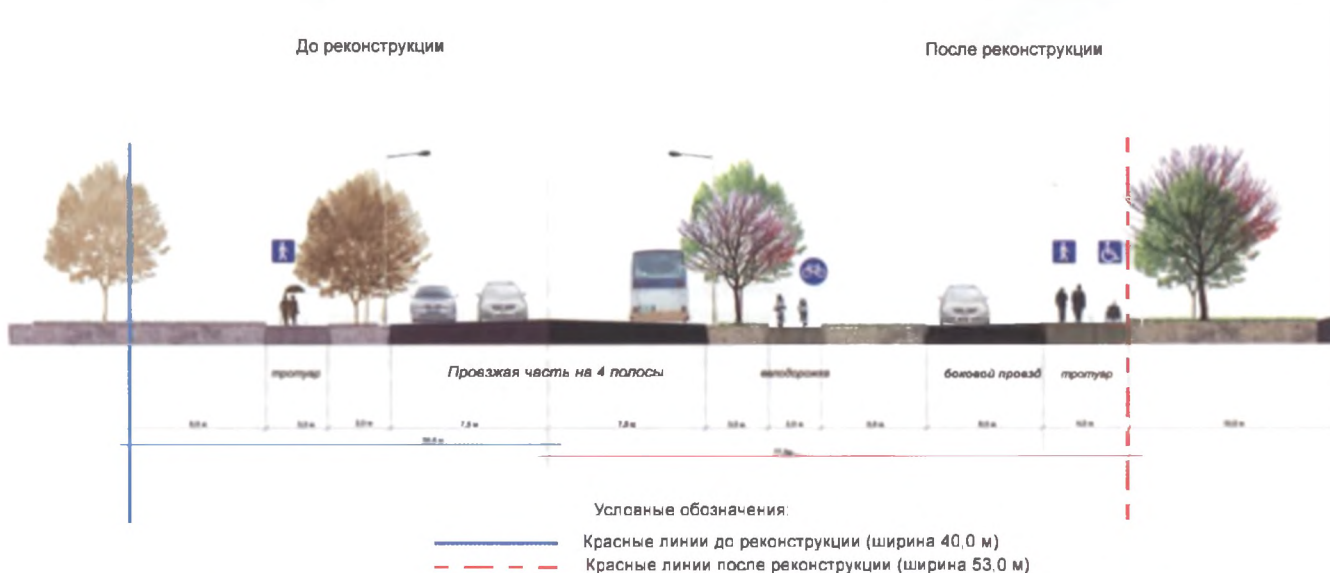
Рис. 4. Изменение поперечного профиля улицы при включении велосипедной дорожки и пути движения ФОЛ
