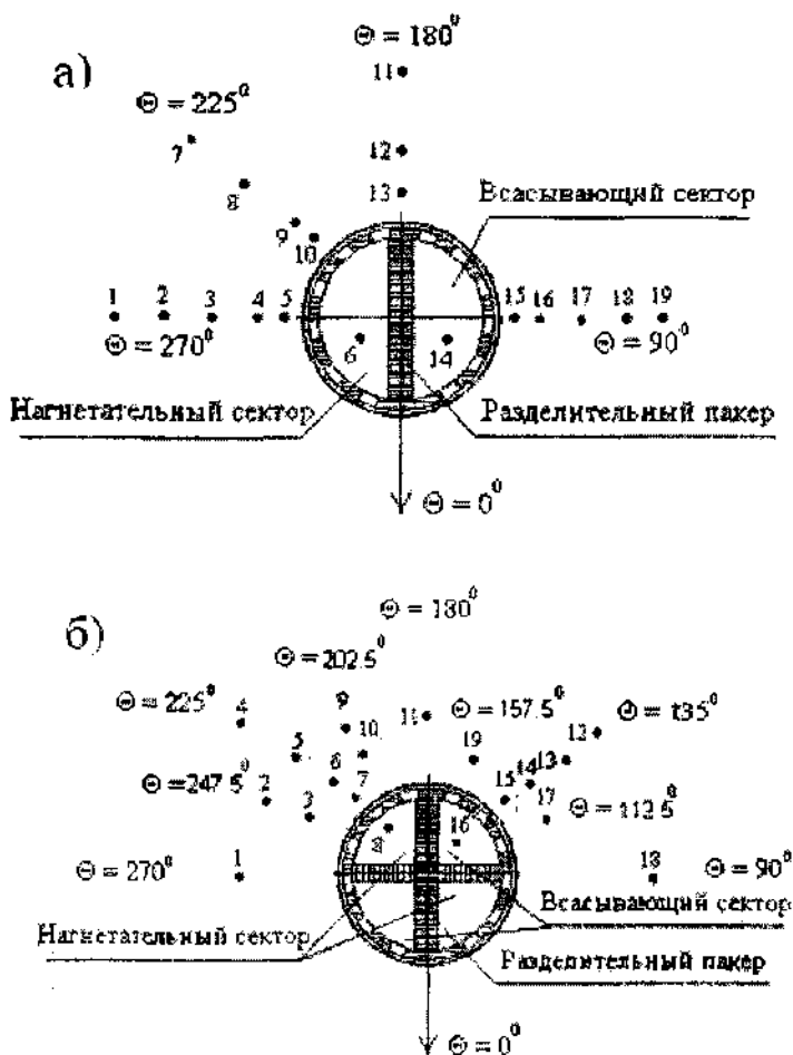
Рис. 4.4. Схема размещения пьезометров: а – при делении фильтра на два сектора; б – при делении фильтра на четыре сектора
